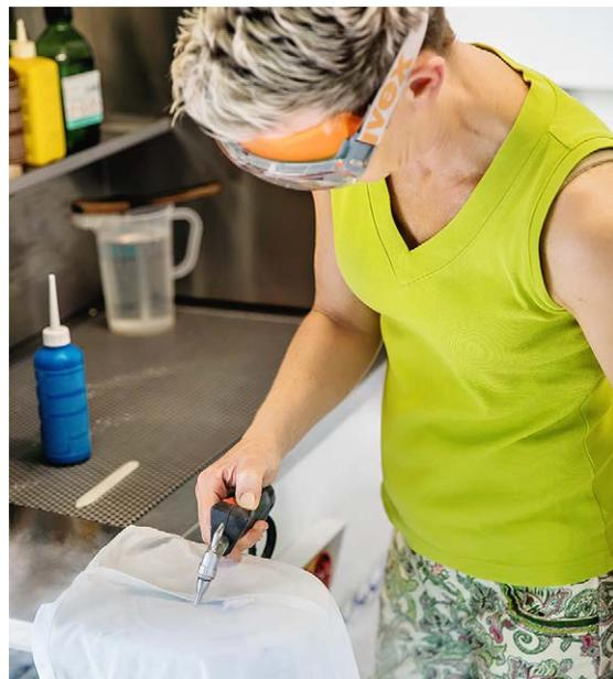
Bild 1: Detachiertisch für das Entfernen kleiner Flecken.
