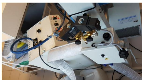
Steuerung und Installation des Doppelbetriebs des Bügeltisches.
