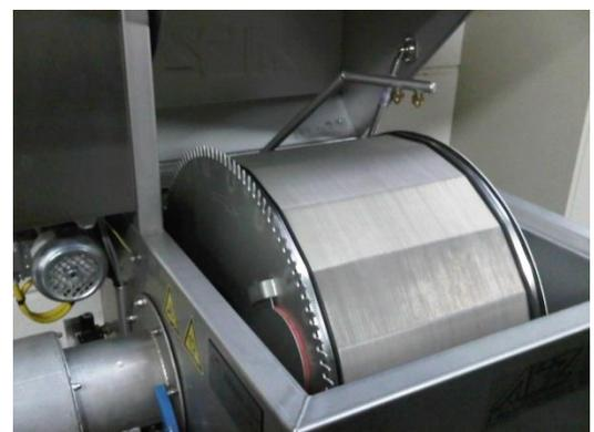
*Rotationsflusenfilter: Aussenansicht mit Ausschub des Filtermaterials resp. der Flusen (links) und Innenansicht mit Rotations-Filterelement (rechts). Bild: ABZ - Zierler GmbH*
