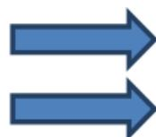
Die Stoffe werden nebeneinander in gleicher Richtung geführt. Beispiel: Rohr-in-Rohr Luft-Wasser Wärmetauscher für Mangelabluft zur Erwärmung von Frischwasser.
