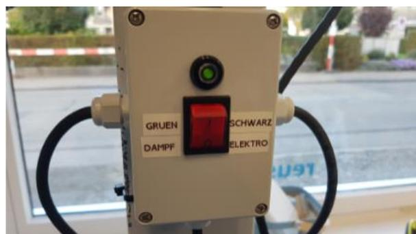
Dieses Bild zeigt die Umschalttaste für den Bügeltisch. Hier kann entweder auf einen kleinen elektrischen Dampfkessel oder direkt auf den Öl-betriebenen Dampferzeuger umgestellt werden.
