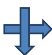
Die Stoffe werden so geführt, dass sich ihre Richtungen kreuzen. Beispiel: Luft-Luft Kreuzstromplattenwärmetauscher in Lüftungs-/Abluftanlagen.
