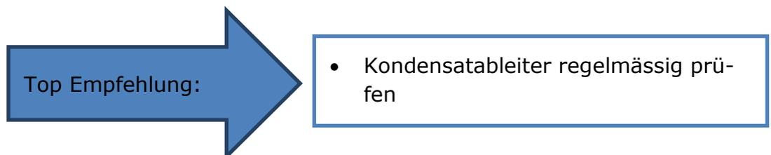
Erfahrungsgemäss ist in Anlagen ohne regelmässige Prüfung/Wartung mit einer Ausfallrate in der Grössenordnung von 15–25 Prozent zu rechnen. Durch regelmässige Prüfungen (mindestens einmal jährlich) und entsprechenden Wartungen lässt sich diese Ausfallrate deutlich auf ca. fünf Prozent verringern. Prüfen lassen sich in Betrieb befindliche Kondensatableiter mittels Schaugläsern, Schall- oder Niveaumessungen.
