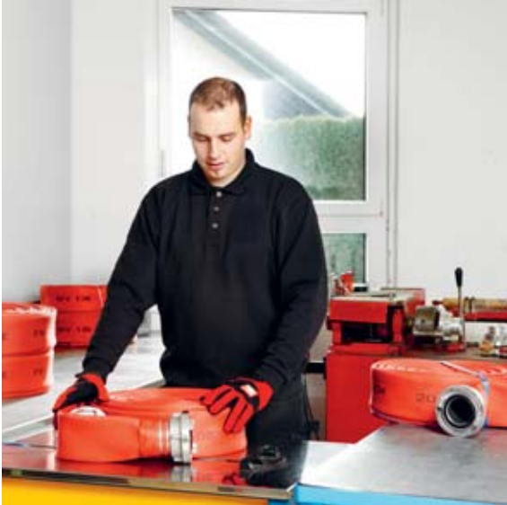
Beim Arbeitsablauf darauf achten, dass sich die Arbeitsebenen möglichst auf gleicher Höhe befinden.
