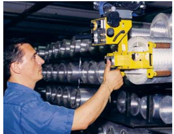
Die Firma hat sich «STOP – Hirne bim Lüpfe» gesagt: Heute wird die gleiche Arbeit mit einem Hebegerät (Gewichtsbalancer) ausgeführt. Durch die Mechanisierung ist die Arbeit wesentlich sicherer, gesundheitsverträglicher und wirtschaftlicher geworden.
