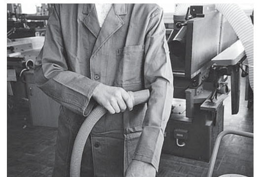
Bild 7: Nicht mit Druckluft abblasen, sondern absaugen.
