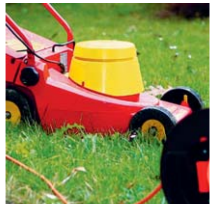
Bild 3: Fatale Gefahr, besonders wenn der FI-Schutzschalter fehlt.
