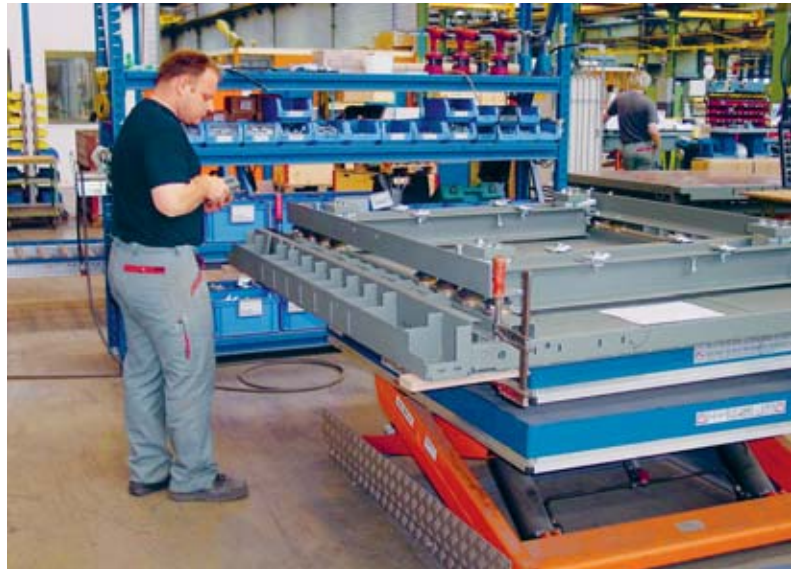
Bild 4 Ein typischer Steharbeitsplatz an einer Scherenhubbühne.
