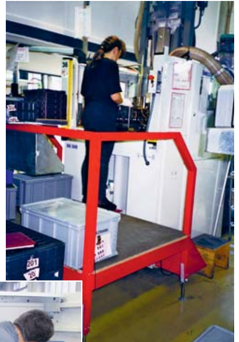
Bild 20 Elektrisch höhenverstellbares Arbeitspodest.
