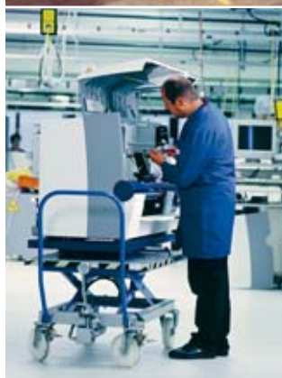
Bild 19 Hubwagen mit Fusspedal zur Höhenverstellung.
