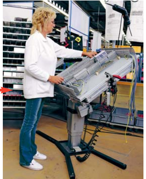
Bild 8 Der höhenverstellbare und neigbare Montagegeständer ermöglicht eine korrekte Körperhaltung.
