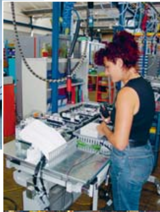
Bild 17 Elektrisch höhenverstellbarer Montagegeständer.
