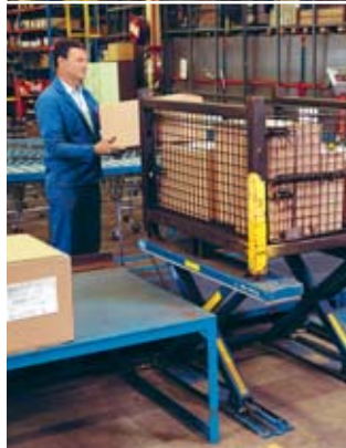
Bild 18 Elektrischer Hubtisch zum Be- und Entladen von Transportbehältern.
