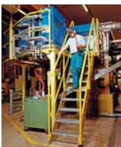
1 Ortsfeste Arbeitsbühne mit Geländer
