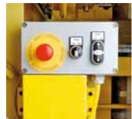
5 Tippsteuerung mit Not-Halt
