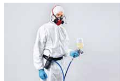
3 Druckluft-Schlauchgerät mit Halbmaske, Chemikalienanzug und Handschuhen
