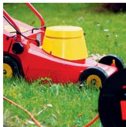
Fig. 3: risque d'électrocution, en particulier en l'absence de dispositif différentiel résiduel (DDR).
