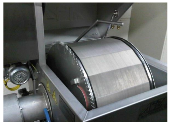
Filtre à peluches rotatif de marque ABZ - Zierler GmbH: extérieur avec récupération du matériau filtrant ou des peluches (gauche) et intérieur avec élément de filtrage rotatif (droite). (Photo: ABZ - Zierler GmbH)
