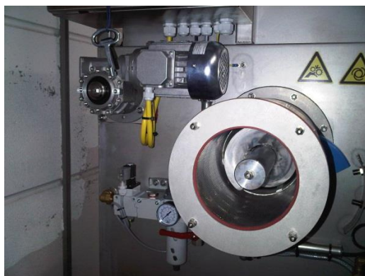
Filtre à peluches rotatif de marque ABZ - Zierler GmbH: extérieur avec récupération du matériau filtrant ou des peluches (gauche) et intérieur avec élément de filtrage rotatif (droite). (Photo: ABZ - Zierler GmbH)
