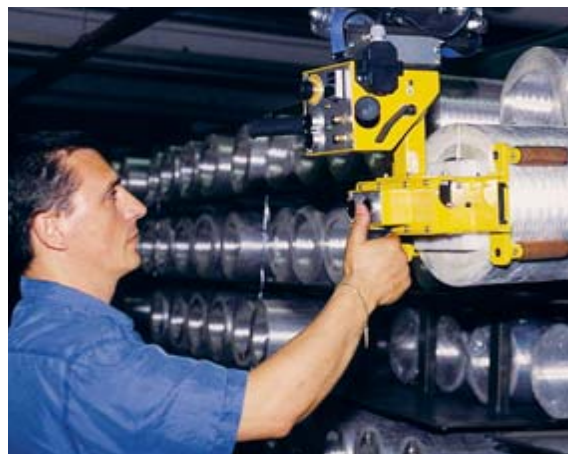
L'entreprise a dit «STOP – portez futé» et les bobines sont désormais déplacées à l'aide d'un engin de manutention (équilibrer). La mécanisation a rendu le travail beaucoup plus sûr, plus sain et plus économique.
