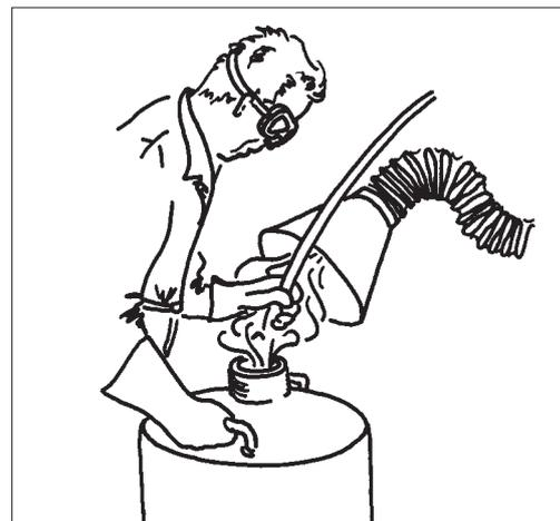
Fig. 4: aspiration des vapeurs corrosives.
