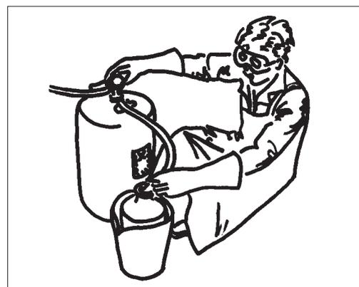
Fig. 6: transvasement avec une pompe manuelle.
