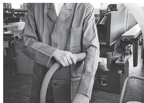
Fig. 7: ne pas souffler avec de l'air comprimé, mais utiliser un aspirateur.
