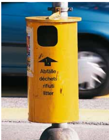
Figure 4 Récipient à déchets dont l'ouverture rend difficile la pénétration de la main et diminue ainsi le risque de se blesser sur des aiguilles ou des objets tranchants qui en dépasseraient.
