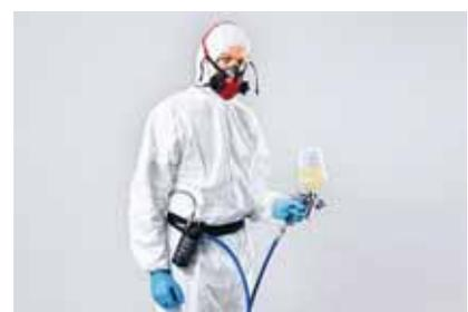
3 Appareil à air comprimé avec demi-masque, combinaison de protection et gants de protection
