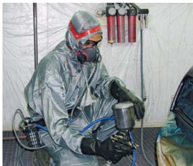
4 Giclage au pistolet d'une peinture solvantée. Protection respiratoire au moyen d'un appareil à apport d'air frais
