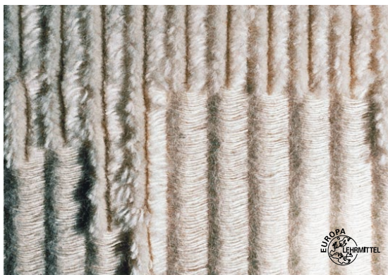
Bild 6: Rohgewebe Cord- oder Rippensamt, teilweise aufgeschnitten.
