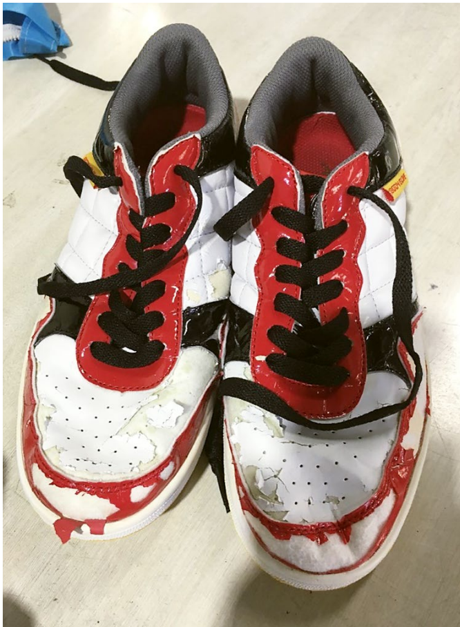
Verstärkung der Beschädigung durch die Hydrolyse bei der Nassreinigung.
