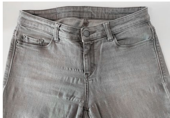
Bild 2: Wellige Banden sind deutlich im Schrittbereich der Jeans zu erkennen.
