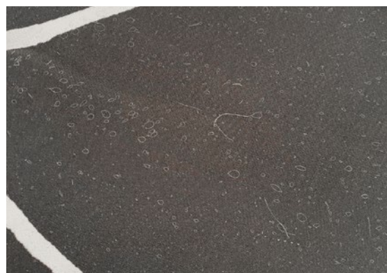
Bild 3: Der Oberstoff zeigt flächig kleine Schlaufen. Elasthanfilamente sind aus dem Gewebeverband herausgetreten.
