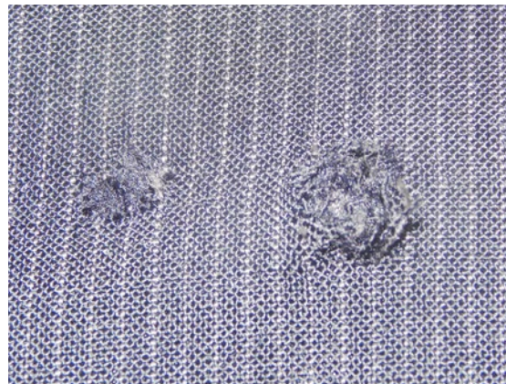
Bild 4: Schaden an Sakko aus Mischgewebe.
