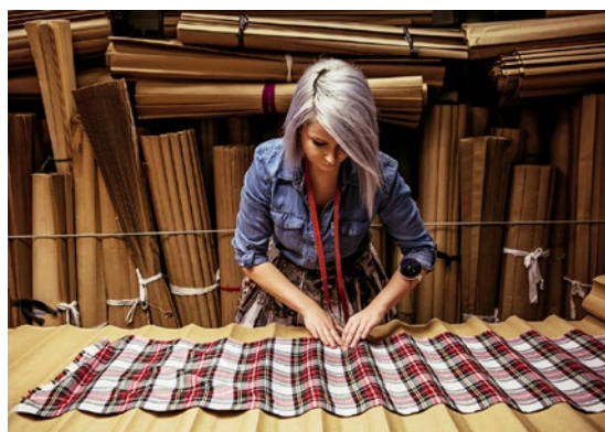
Bild 2: Der zu plissierende Stoff wird glatt auf das gespannte Unterblatt gelegt.
