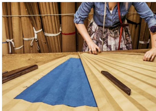
Bild 3: Nachdem das Oberblatt aufgelegt wurde, wird die Plisséeschablone zusammengescho- ben. Die Falten werden «ingelegt».
