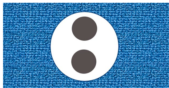
Bild 10: Platzbedarf in der Nähgutmitte beim Doppelkettenstich.
