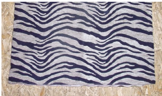
Bild 1: Die Schrumpfung des Oberstoffes bei einem Kissenbezug ist deutlich an der Welligkeit des Reissverschlusses zu erkennen.
