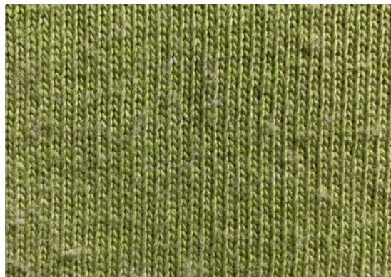
Bild 2: Maschendichte: Je gröber die Maschenware, desto anfälliger ist sie für die Bildung von Faserknötchen.
