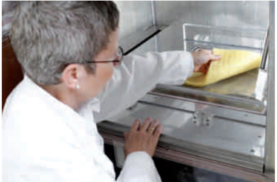
Mit Hilfe des sogenannten Hautmodells wurden die Atmungsaktivität und Wärmeisolation verschiedener textiler Materialien untersucht.
