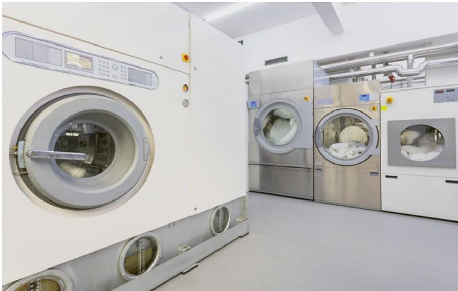
Die Investitions- und die Energiekosten sind bei einer Reinigungsmaschine mit Destillation höher als bei Maschinen ohne Destillation.
